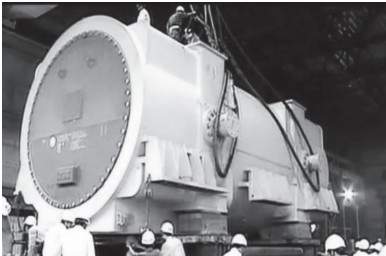
圖 5-2 中共潛艦用核反應爐早期構型
