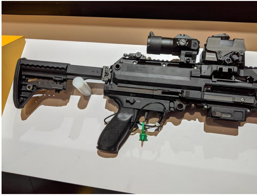
圖 3、NGSW-AR (XM250) 的保險細節
