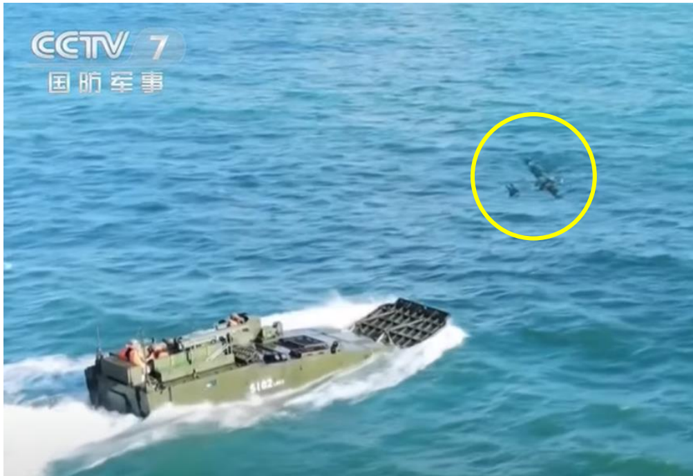
附圖 1、兩棲裝甲履帶車進行水上動態無人機施放作業
