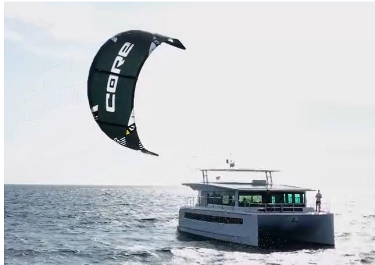
圖 3、結合風帆與太陽能板的雙體船
